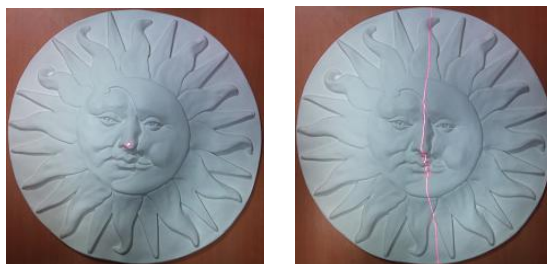
FIGURE 1.8 – Triangulation active : a. La lumière projetée est un point laser b. La lumière projetée est une ligne laser.
