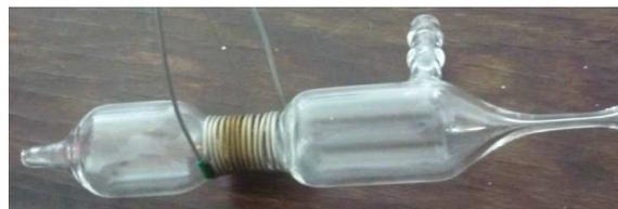
Figure 2.2 – Four utilisé pour étirer les fibres de chalcogénure. La résistance chauffante et le rétrécissement du diamètre du cylindre dans cette zone permettent de maintenir une température suffisamment élevée pour rendre la fibre visqueuse et pouvoir l'étirer. Un embout est prévu pour faire circuler un flux de gaz inerte et chasser l'air de la zone chaude.
