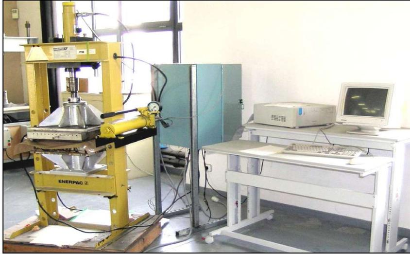
Figure 2.21 : Presse chauffante utilisée pour la fabrication des plaques
