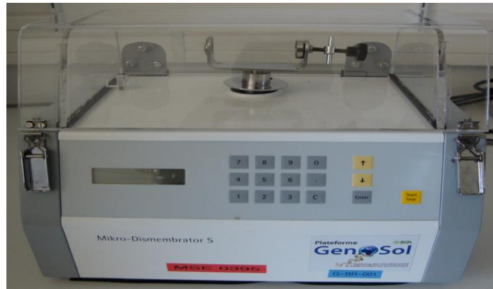
Photo II-4. Mini-bead beater disrupter (Mikro-Dismembrator S, Sortorius)
