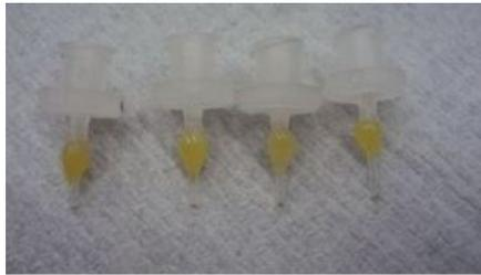
Figure 5.4 – Les quatre buses en verre [Minov et al., 2015b]
