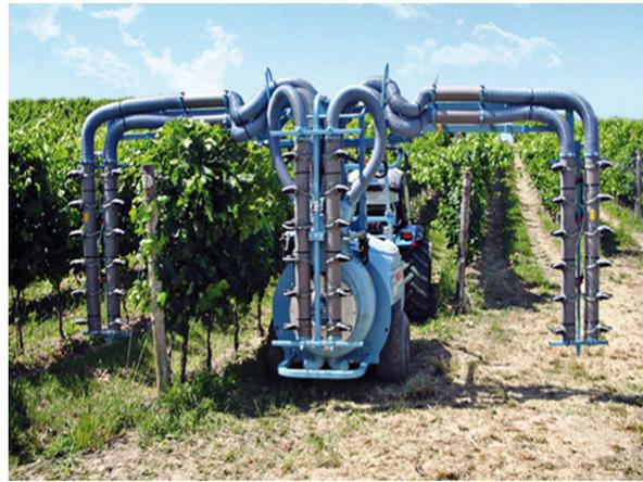
Figure 2.6 – Pulvérisateur pneumatique, source Institut Français de la Vigne et du Vin (IFV)
