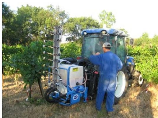
Figure 2.8 – Pulvérisation électrostatique, source Irstea
