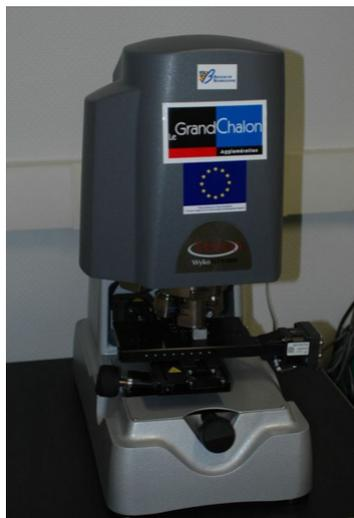
Figure 3.5 – Rugosimètre interférométrique de l’IUT de Chalon-sur-Saône
