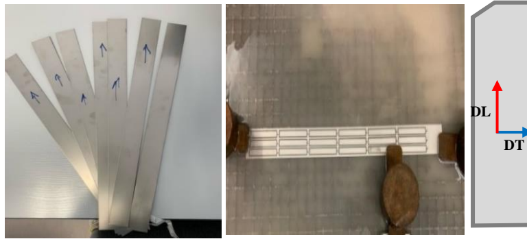
Figure 71: Tôle T40 découpée au jet d'eau pour obtenir une section d'échantillons de 100 X 10 mm 2 . La flèche ↑ indique le sens de laminage).
