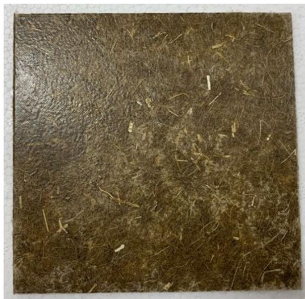
FIGURE 3.16 – Composites 100 % biosourcés imprégnés en voie sèche.
