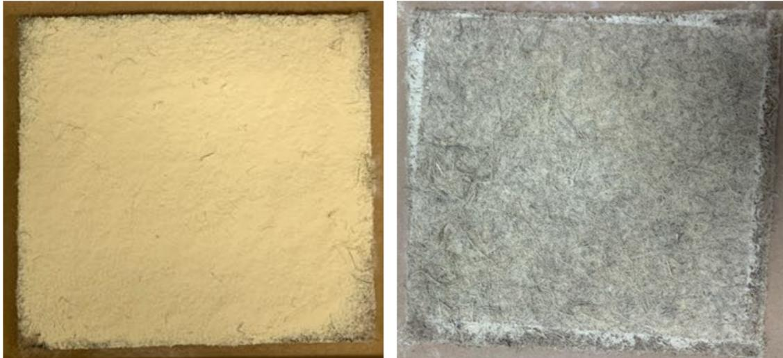
FIGURE 3.15 – Imprégnation d'un mat de lin. À gauche : poudre tamisée à 100  $\mu\text{m}$  déposée à la surface du mat. À droite : résultat après application du champ électrique ; la poudre a pénétré le réseau de fibre.
