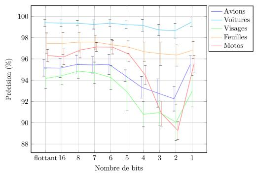
Précision de HMAX en fonction du nombre de bits dans les filtres de Gabor filter
