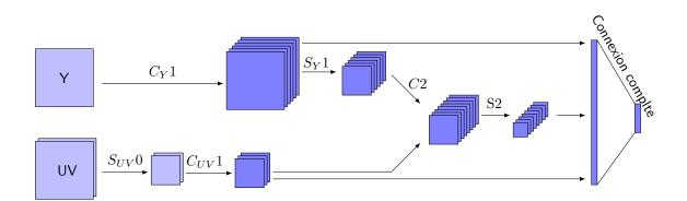
FIGURE B.16: ConvNet pour la détection de piétons [145]. Les couches  $C_{XX}$  désignent des couches de convolutions, et les couches  $S_{XX}$  désignent des couches de souséchantillonage.
