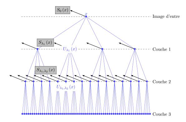
FIGURE B.4: Invariant scattering convolution network [38]. Chaque couche applique une décomposition en ondelette  $U_{\lambda}$  à l'entrée, et envoie le résultat auxquels a été appliqué un filtre passe-bas et un sous-échantillonage à la couche suivante. Les *scattering coefficients*  $S_{\lambda}(x)$  ainsi produits forment le vecteur caractéristique à classifier.
