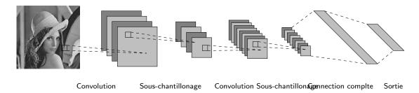
FIGURE B.6: Réseaux de neurones à convolutions [48].
