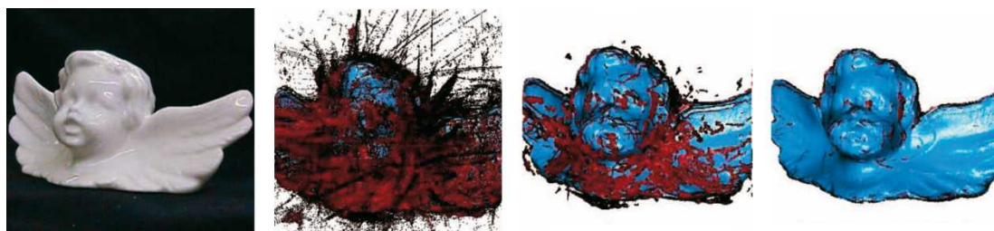
Figure 2-20 – Reconstruction 3D d'une pièce en céramique par suppressions itératives des points faux
