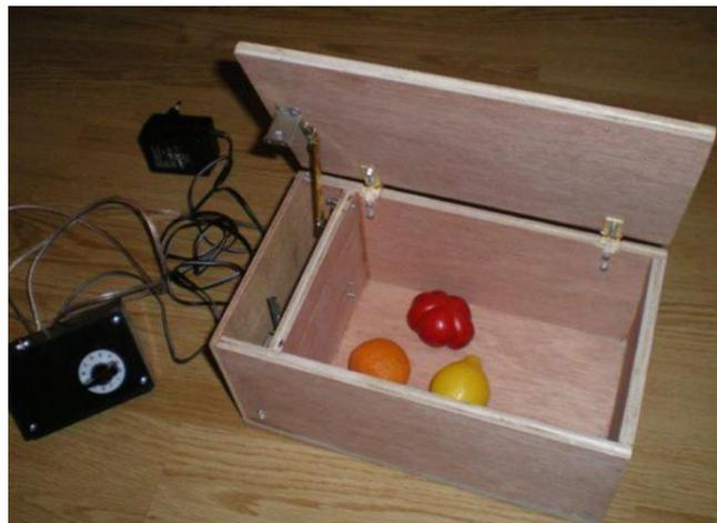
Figure 7.1 Boîte et son dispositif électronique d'ouverture minutée
