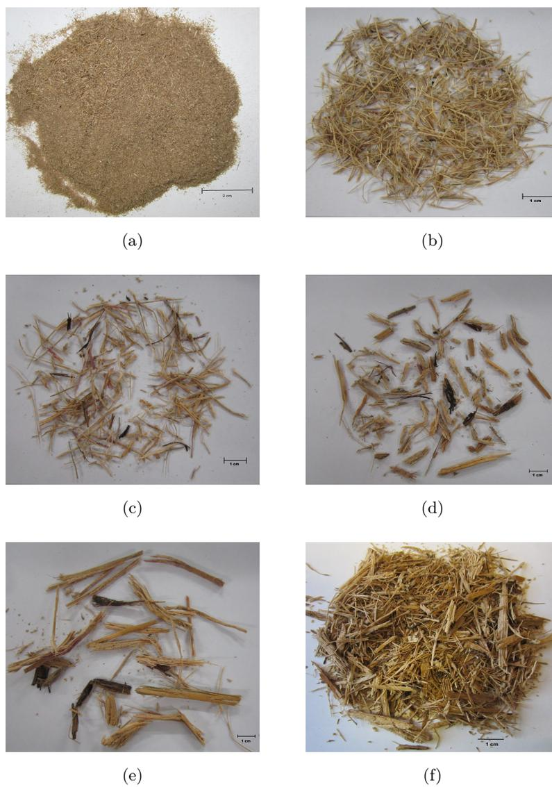
FIGURE 2.3 – Fibres de bagasse tamisées (a) B0 ( b) B05 (c) B1 (d) B2 (e) B4 et (f) BE.
