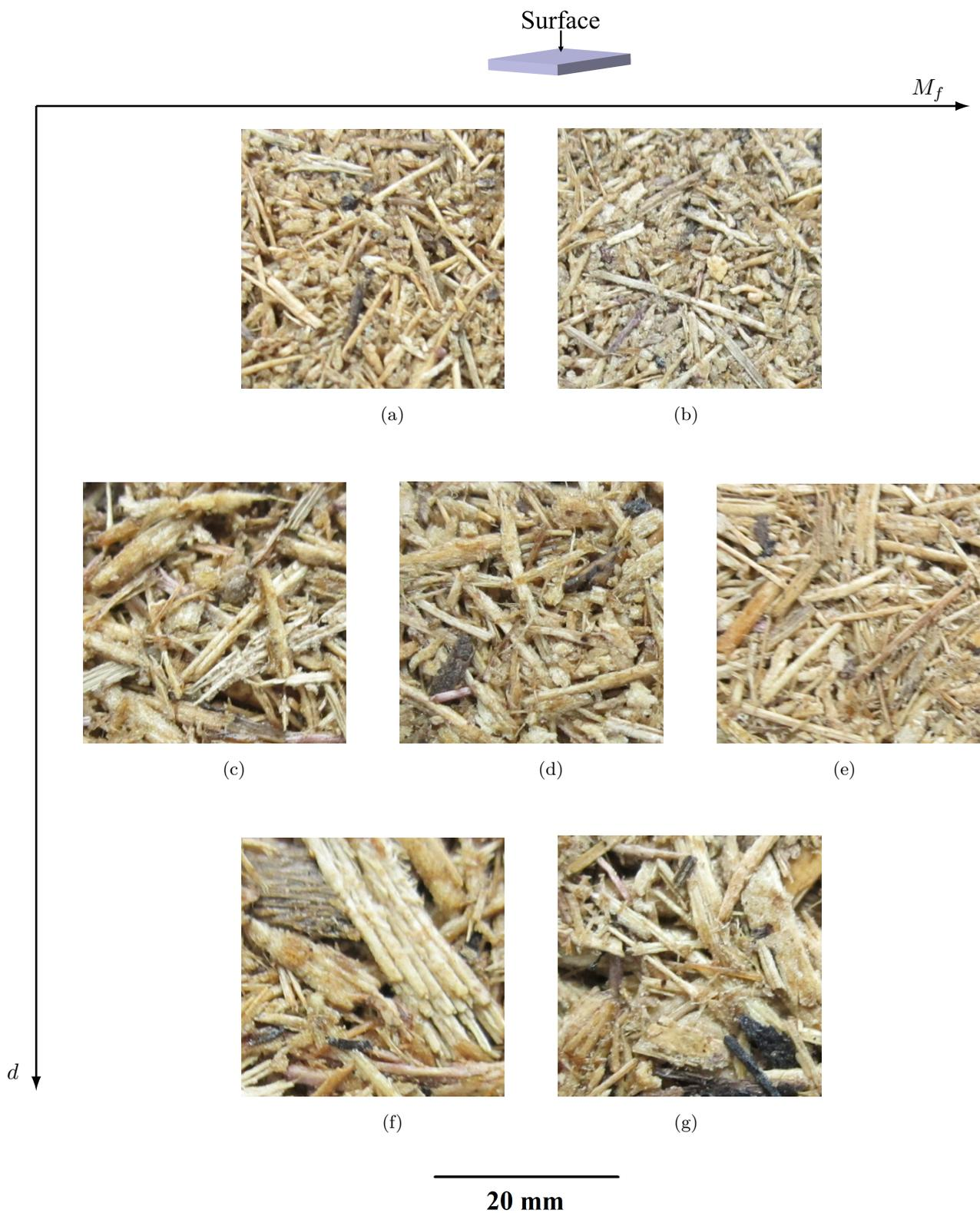
FIGURE 2.23 – Vues suivant le plan (xy) de la structure des composites B05\_47 (a), B05\_62 (b), B1\_40 (c), B1\_45 (d), B1\_70 (e), B2\_47 (f) et B2\_62 (g), en fonction du taux massique  $M_f$  et diamètre  $d$  des fibres
