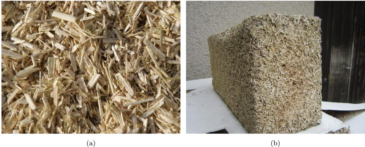
FIGURE 1.7 – Chènevotte (a) et bloc de béton de chanvre (b) [58]
