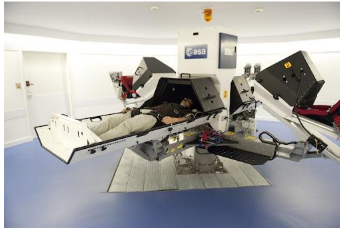
Figure 15 Centrifugeuse à bras court utilisée pour différentes études cliniques confiées à la Clinique Spatiale de Toulouse (MEDES). Ce dispositif permet de recréer une gravité artificielle par centrifugation. Source : www.medes.fr
