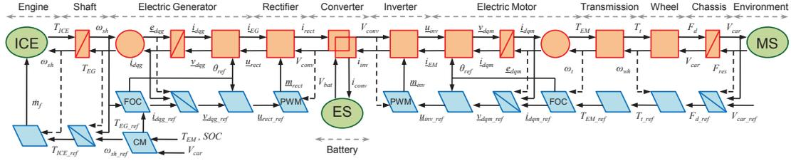
Figure 7.5: Représentation énergétique macroscopique du système de voiture et de son système de contrôle.
