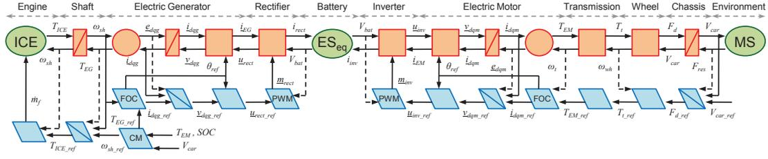
Figure 7.6: Représentation énergétique macroscopique du système de voiture et de son système de contrôle à la source électrique équivalent.
