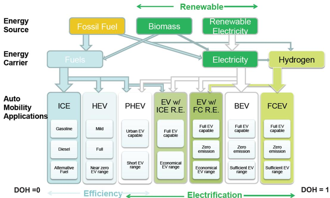
Figure 7.1: Représentation schématique de types de VHE avec écoulement dans les sources d'énergie et de concentration de conception (extrait iTEC 2012 petit cours sur VHE Fundamentals par M. Zhang) [27].
