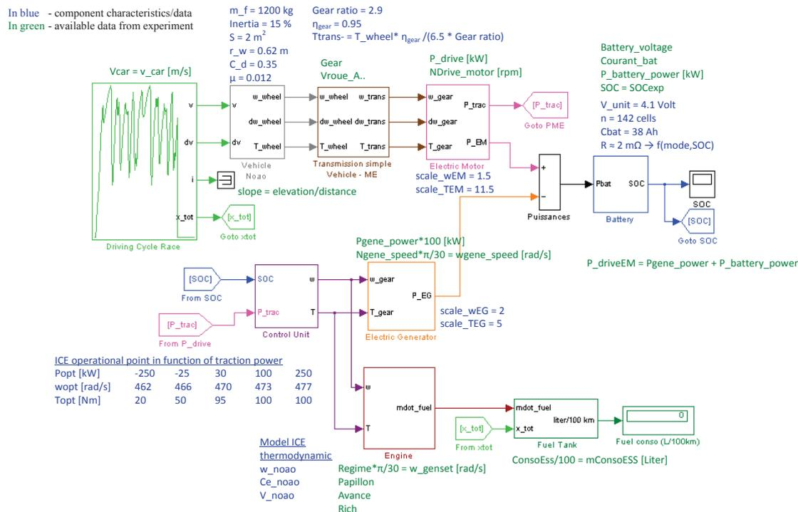
Figure 7.4: Modélisation de la voiture NOAO utilisant la méthode de modélisation quasi-statique.
