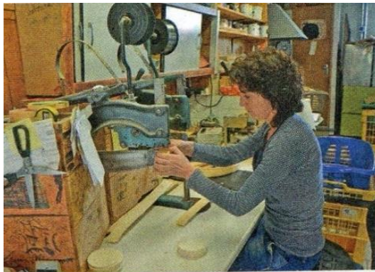
Figure 45: Véronique fabriquant 1 millier de boîtes de mont d'or par jour avec l'agrafeuse à fil achetée par le grand-père dans les années 70.
