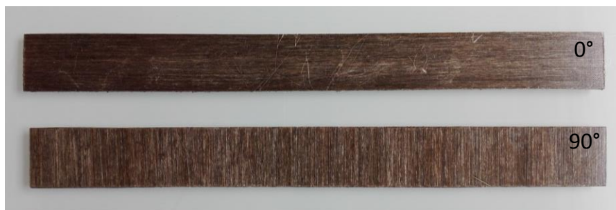
Figure 27 : Éprouvettes de composite unidirectionnel (0° et 90°).
