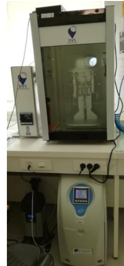
Figure 32 : Mesures DVS sur les fibres de lin et sur le composite lin/époxy (à gauche) et SMS DVS-Advantage (à droite).
