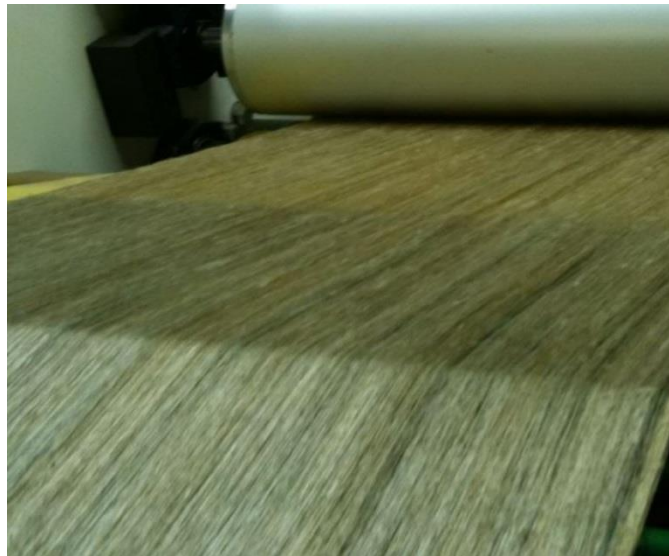
Figure 23 : Renfort purement unidirectionnel FlaxTape™.
