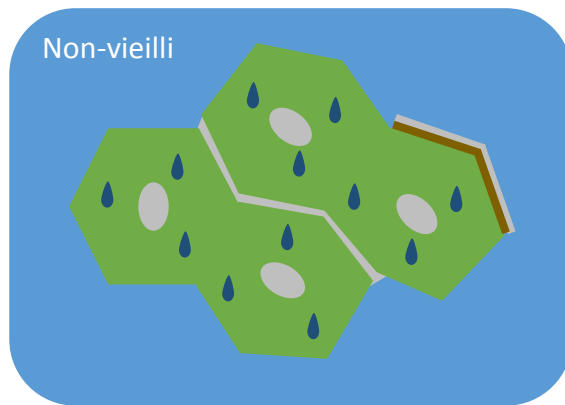
Non-vieilli a) Adhésion fibre/matrice imparfaite dans certaines zones et quelques décohésions fibre/fibre au sein de certains faisceaux (MEB)
