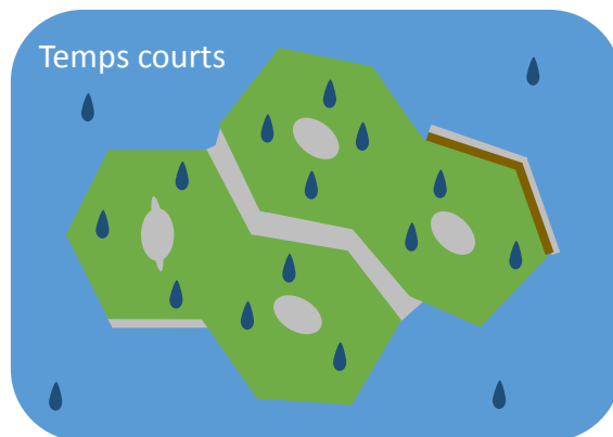
Temps courts b) Endommagements interfaces et initiation de fissures dans certaines fibres (MEB) qui provoquent une chute de \sigma_{\max} + « stockage » d'eau dans la matrice (DVS) qui induit une plastification de la matrice (mDSC) et une chute de module (traction).
