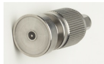
Fig. 2.4 – Exemple d'une sonde utilisée pour les mesures radio et hyperfréquences [97].
