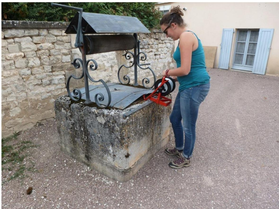
Figure 8 : Mesure du niveau piézométrique dans un puits communal à Cravant (89).
