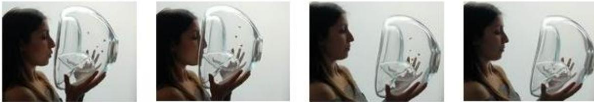
*Photo 6 : Dispositif de verre à deux enceintes utilisé pour la détection d'odeur par les abeilles.*
