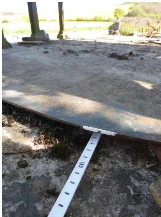
Illustration 5 : Photographie de la mesure d'un niveau d'eau grâce au ruban métrique de la sonde piézométrique et du repère.
