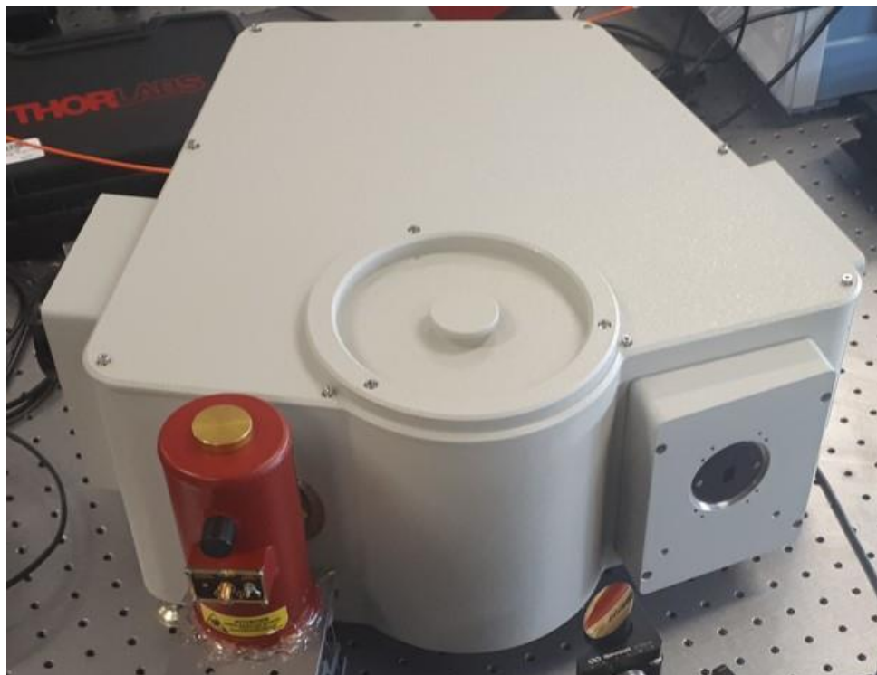
Figure IV 5-3 : Monochromateur Horiba iHR 320 et détecteur MCT placé en sortie.
