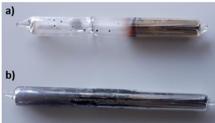
Figure III 2-3 : Ampoule de silice contenant un verre de chalcogénure après l'étape de recuit avec une trempe dans l'eau réalisée à deux températures différentes : 575 °C (a) et 600 °C (b).
