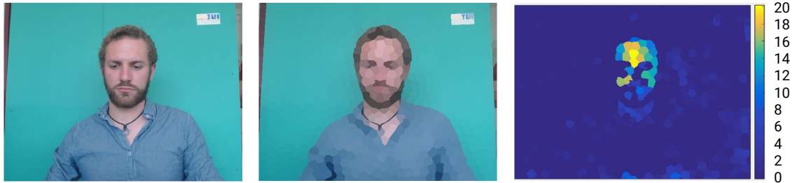
FIGURE 4.1 – Qualité du signal rPPG pour chaque superpixel temporel avec de gauche à droite : image d'entrée, segmentation en superpixels temporels et qualité du signal rPPG (la qualité de la mesure est meilleur dans les tons jaunes/oranges, elle est exprimée en dB).
