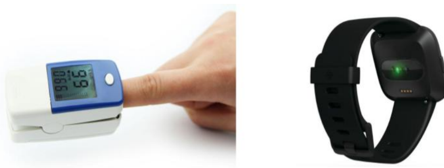
FIGURE 1.1 – Exemple de système pour la mesure cardiaque. Dans un cadre médical (gauche) : oxymètre de pouls, et dans un cadre récréatif (droite) : montre connectée.
