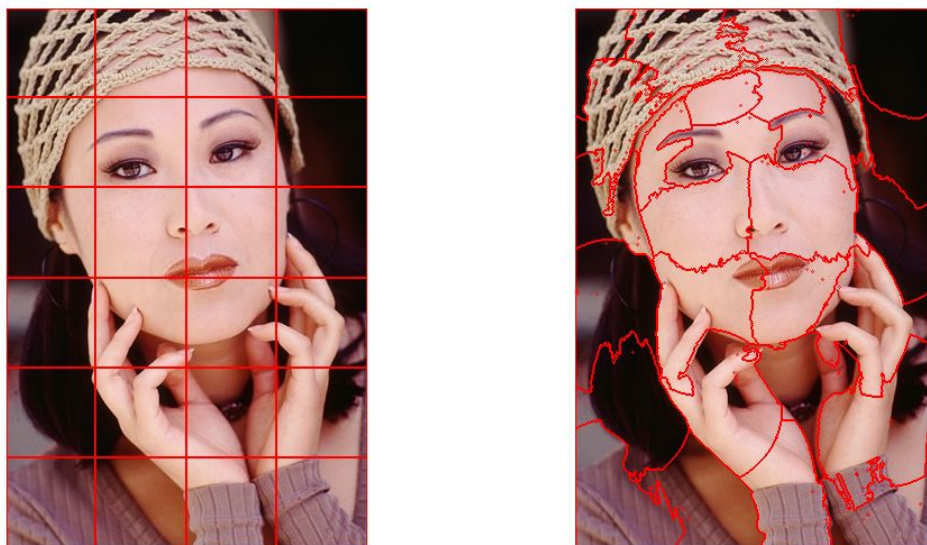
FIGURE 6.1 – Exemple de segmentation par superpixels avec la méthode IBIS avec à gauche la segmentation initiale pour initialiser la méthode et à droite la segmentation finale.
