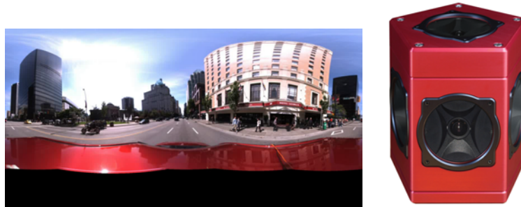
FIGURE 2.9 – (a)Image acquise avec un système multi-caméras (b) Le capteur LadyBug
