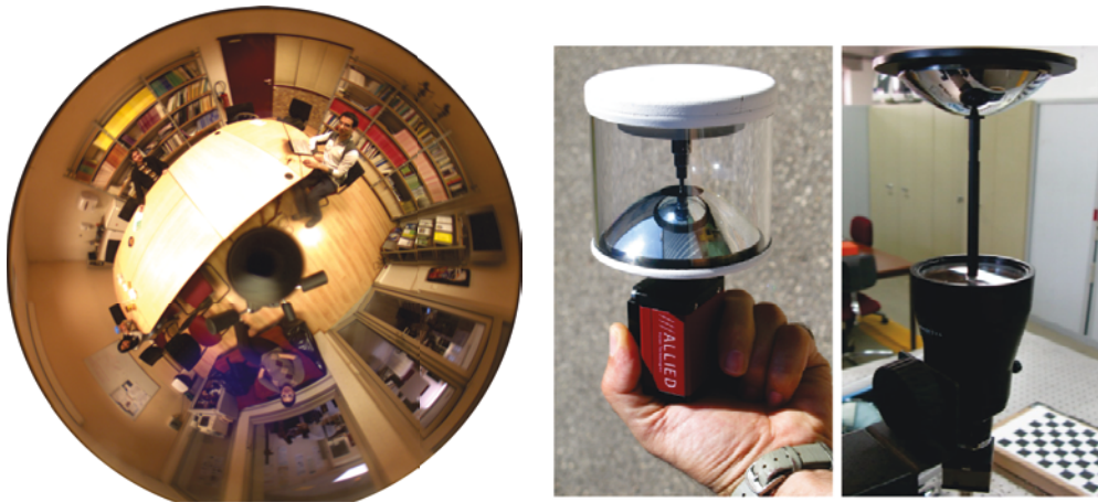
FIGURE 2.10 – (a) Image obtenue à l'aide d'une caméra catadioptrique (b) Différent type de caméras catadioptriques
