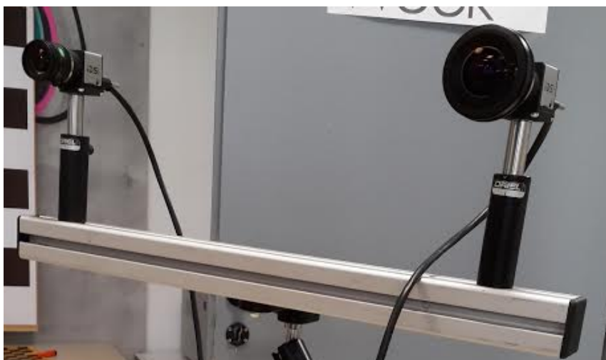
FIGURE 5.7 – Banc stéréo hybride utilisé pour évaluer notre approche de calibrage
