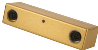
FIGURE 5.2 – Le système de stéréo-vision Bumblebee .
