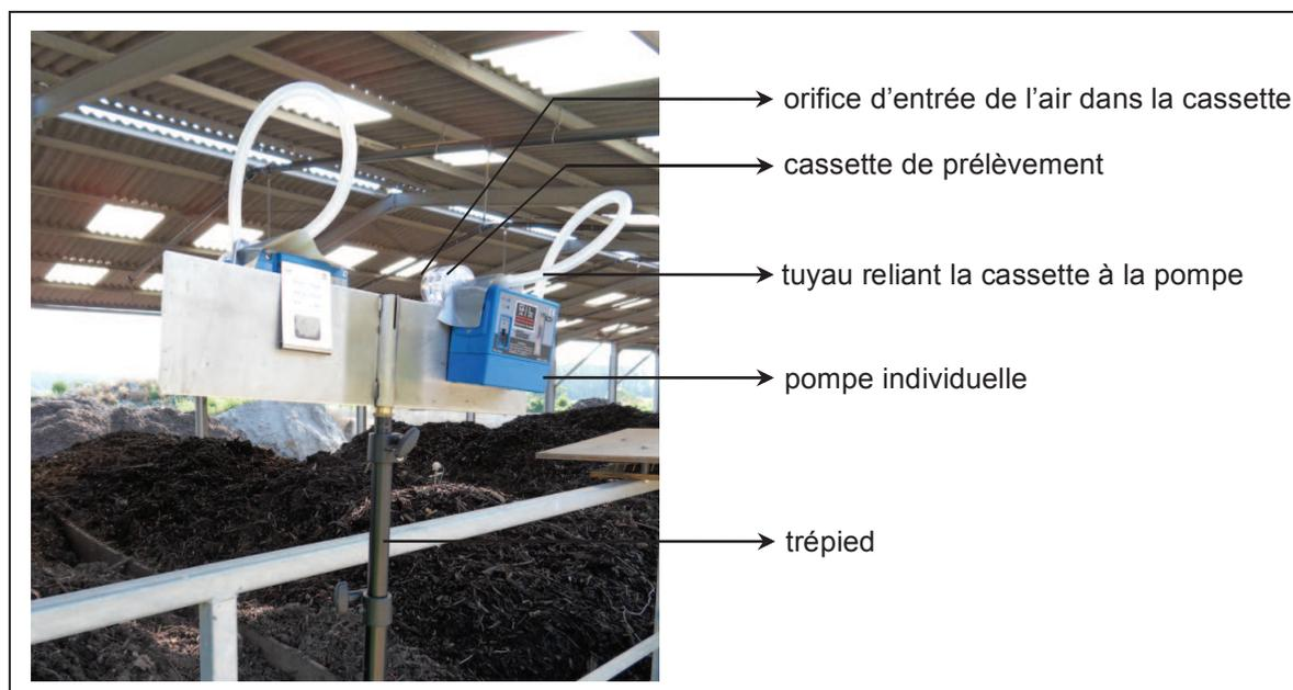
Figure 83. Photographie d'un prélèvement d'air effectué en plate-forme de compostage sur deux cassettes fermées [© Laetitia Betelli / INRS].
