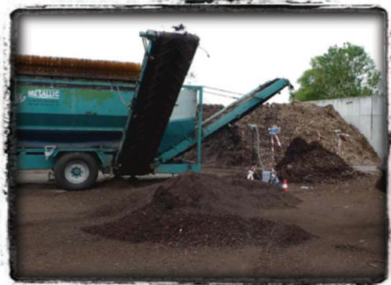
(d) Criblage du compost (cribleuse mobile)
