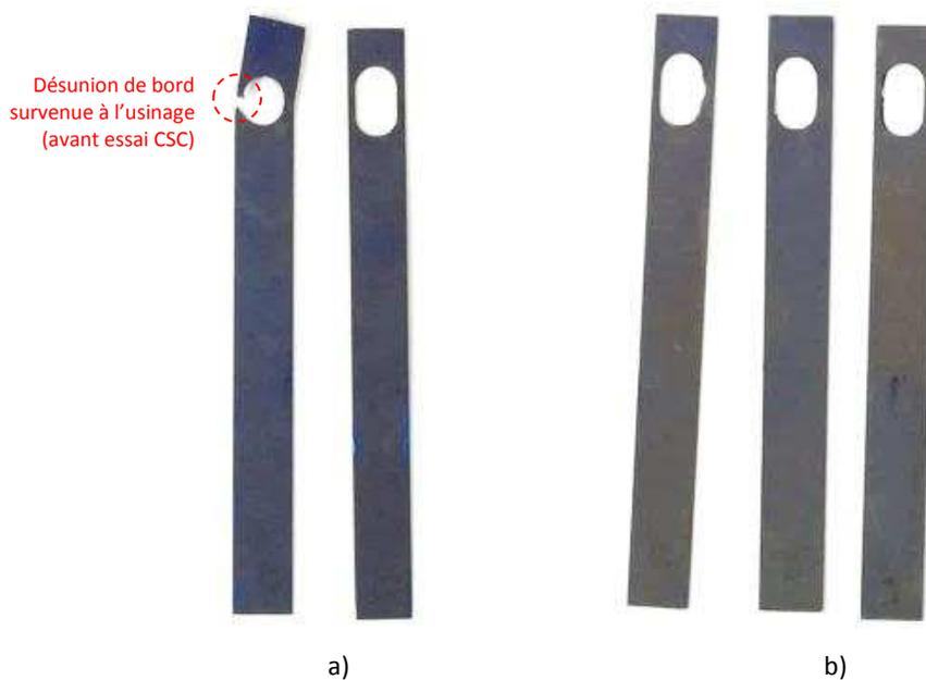
**Figure 110 :** Photographies des lamelles plates a) en T60, et b) en T35, après 500h en autoclave
