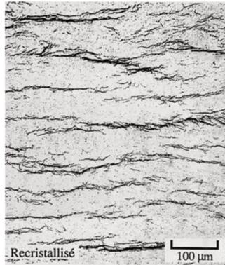
**Figure 100 :** Alignements d’hydrures de zirconium liés à la présence d’un champ de contraintes au sein d’un alliage zircaloy-4 [76]
