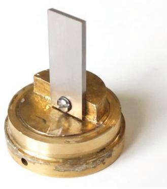
**Figure 16 :** Photographie d'un échantillon vissé à un support en laiton avant enrobage
