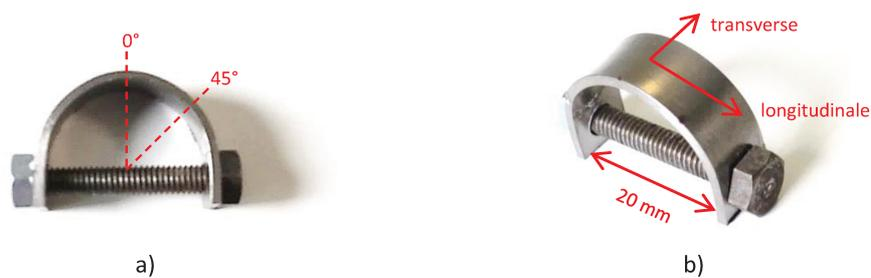
**Figure 80 :** Photographies d'une éprouvette cintrée utilisée pour la mesure des contraintes a) à 0° et 45°, et b) longitudinale et transverse
