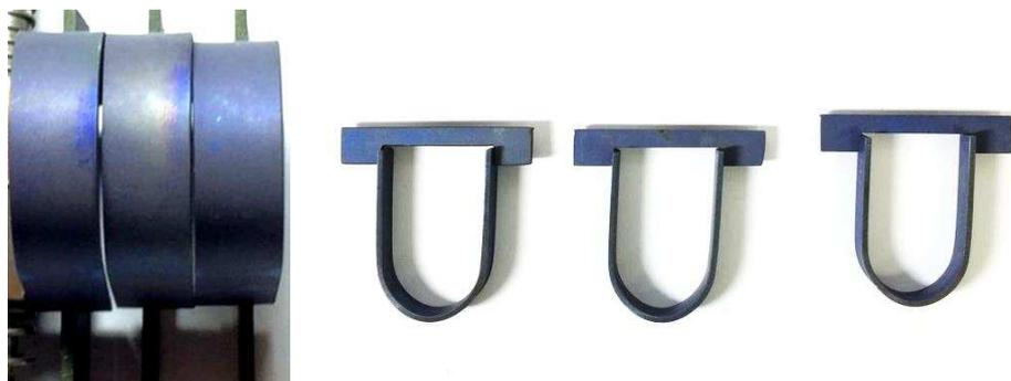
**Figure 104 :** Photographies d'éprouvettes U-bend en T40 B vierges après 500h en autoclave
