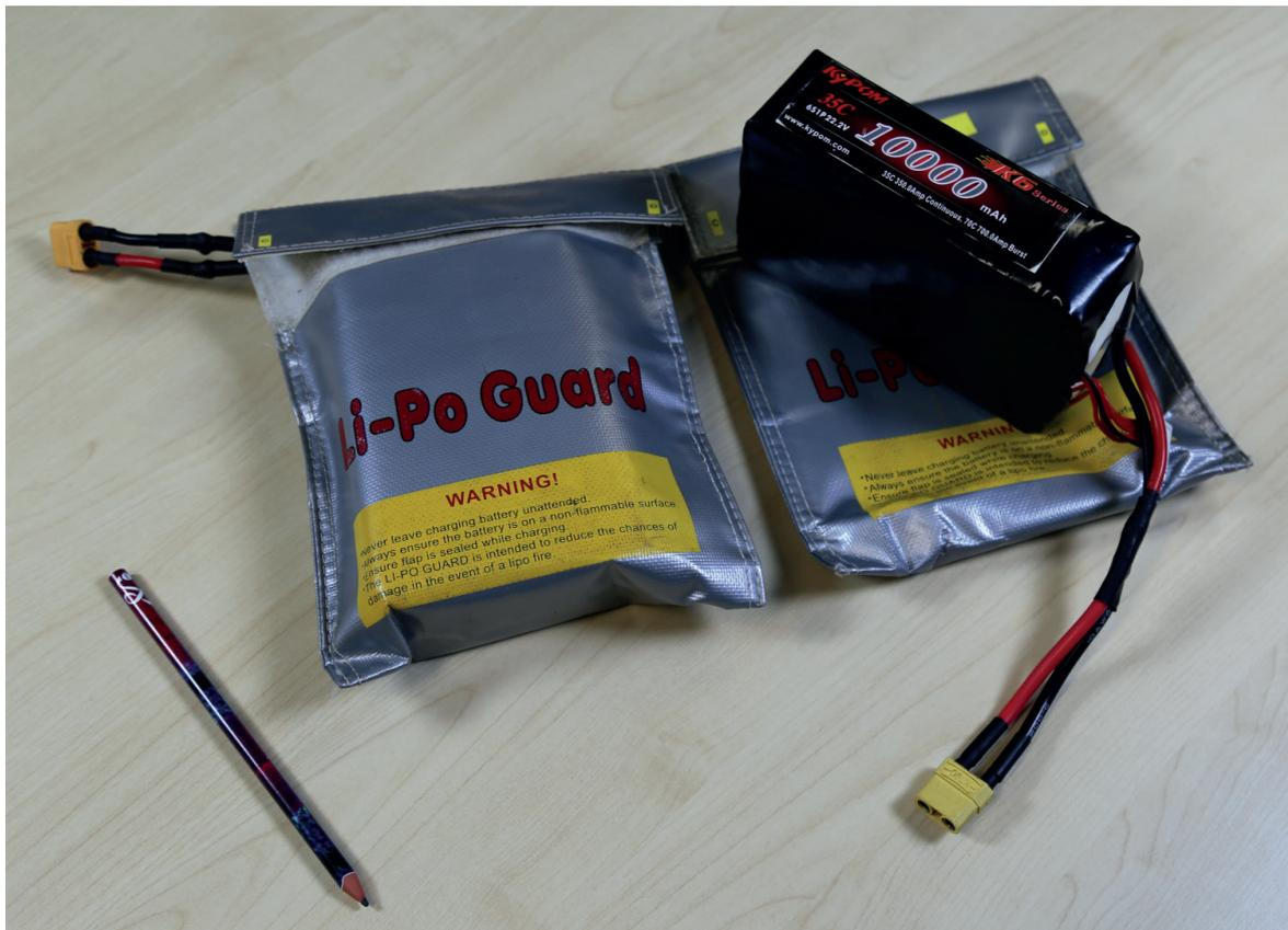
47. Conditionnement des batteries LiPo dans sacs ignifugés
