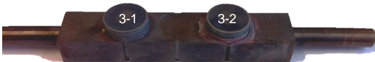
Figure 4-48 : Photographie de la maquette et des échantillons après brasage
