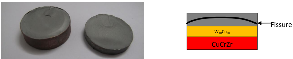
Figure 4-39 : Photographie de l'assemblage composé d'une couche de 1 mm du mélange W_{40}Cu_{60}
