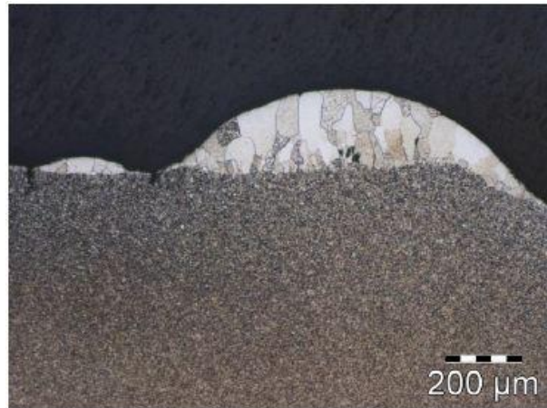
Figure 2-55 : Micrographie MEB de la coupe transversale de l'échantillon W-PTA-2 %-B f ayant subi le chargement C
