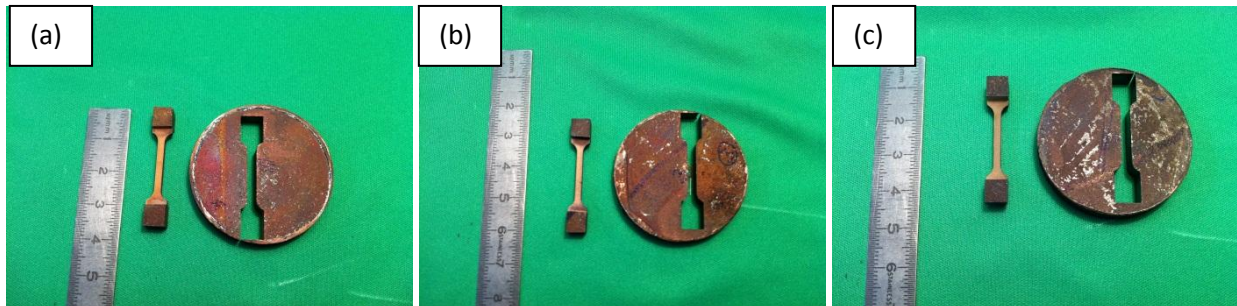
Figure 3-26 : Éprouvettes de traction des échantillons (a) W_{40}Cu_{60} , (b) W_{60}Cu_{40} et (c) W_{80}Cu_{20}
