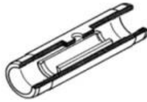
Figure 9 : Schéma d'un récipient de graphite pour SAA-FG (Perkin Elmer).
