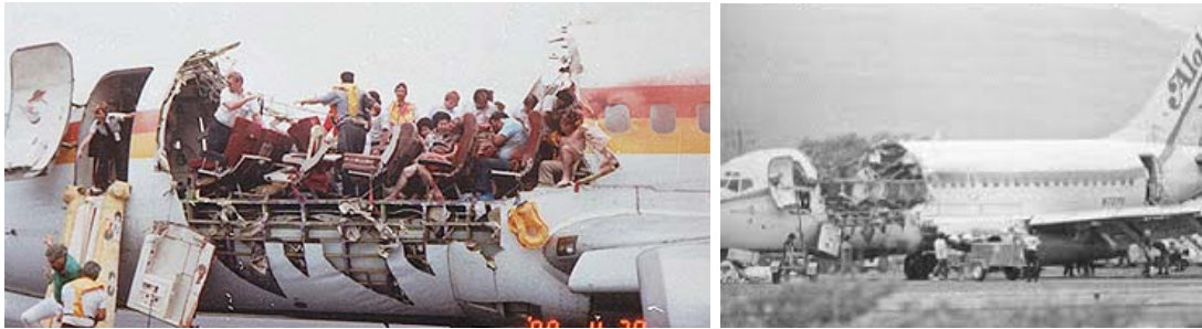
FIGURE 1.1 – Propagation catastrophique d'une fissure de fatigue dans une structure métallique : phénomène d'endommagement non diffus qui pourrait être étudié dans le cadre de la fatigue à l'aide de la Mécanique de la Rupture [9]. Boeing 737 de la compagnie Aloha Airlines, Vol 243, 28 avril 1988, assurant la liaison entre les îles Hilo et Honolulu. Suite à un nombre de cycles décollage/atterrissage très important (89090), et à un environnement agressif (salin, humide et chaud, vols dans l'archipel des îles Hawaï), l'adhésif assurant la liaison entre les plaques d'aluminium du fuselage s'est dégradé et a permis le phénomène de corrosion, qui a amplifié celui de fatigue, conduisant à l'arrachement d'une partie du fuselage de l'appareil.
