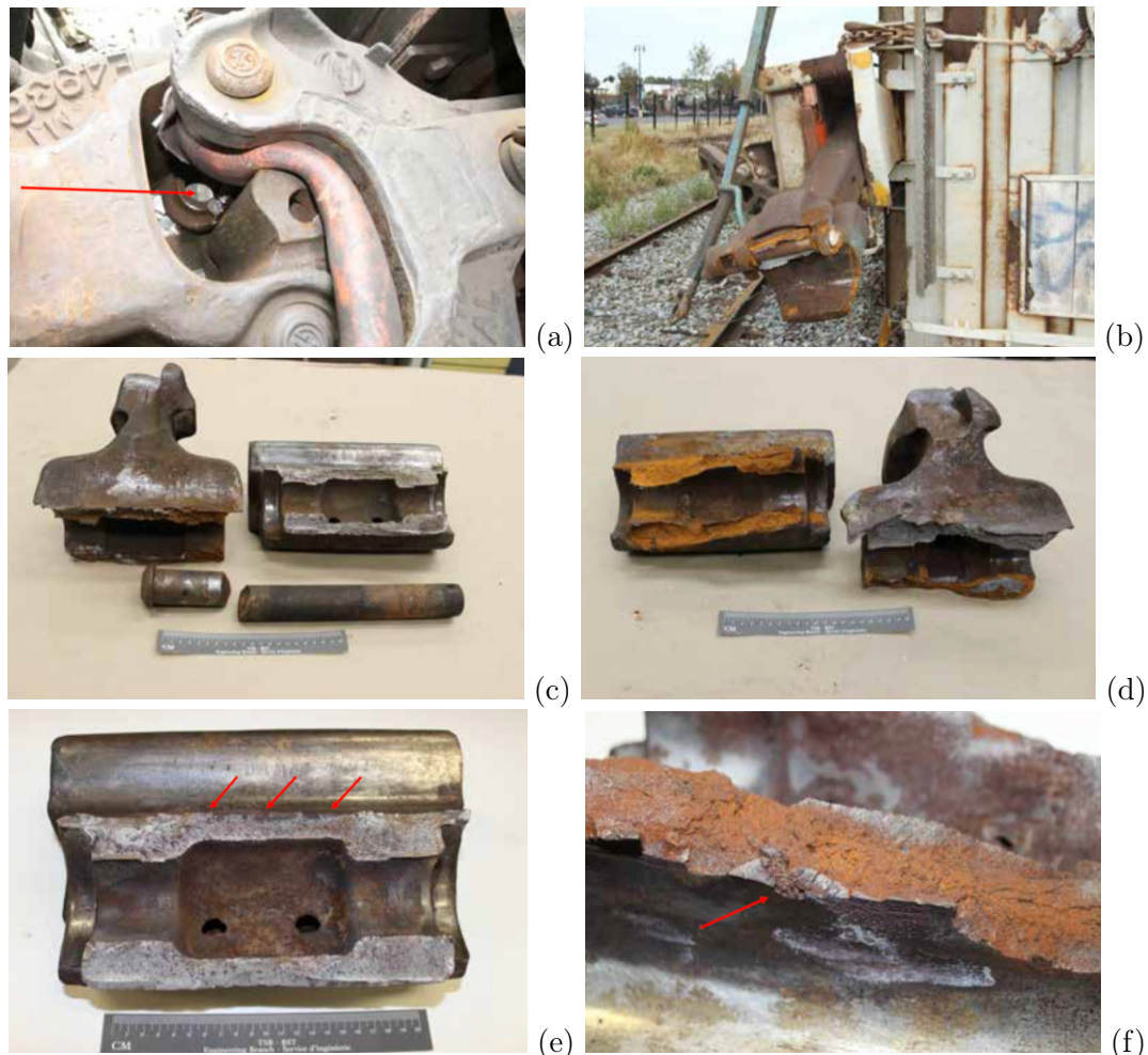
FIGURE 1.3 – Rupture par fatigue d’une structure métallique : phénomène d’endommagement non diffus qui pourrait être étudié dans le cadre de la fatigue à l’aide de la Mécanique de la Rupture. Déraillement d’un train de transport de pétrole brut à Lac - Mégantic (Québec, Canada), le 6 juillet 2013 [15]. Le train comportait 5 locomotives en tête du train, puis un wagon couvert et 72 wagons-citernes. La cause du déraillement est une rupture de deux mâchoires d’attelage initiée par la présence de fissures de fatigue situées en surface des mâchoires : une des deux mâchoires d’attelage arrière de la seconde locomotive, une des deux mâchoires d’attelage avant du wagon couvert accrochée à la dernière locomotive. L’une (nous ne savons pas avec certitude laquelle) des deux mâchoires s’est rompue et a entraîné la rupture de la seconde. (a) Vue en situation de la mâchoire rompue de la locomotive. (b) Vue en situation de la mâchoire rompue du wagon couvert. (c) Mâchoire rompue de la locomotive. (d) Mâchoire rompue du wagon couvert. (e) Surface de rupture de la mâchoire rompue de la locomotive avec l’indication de fissures de fatigue antérieures au déraillement, situées en surface. (f) Surface de rupture de la mâchoire rompue du wagon couvert avec l’indication de fissures de fatigue antérieures au déraillement, situées en surface.
