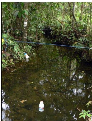
Photo 9 : Mesure de vitesse du courant au sein de la station de mesure grâce aux flotteurs.
