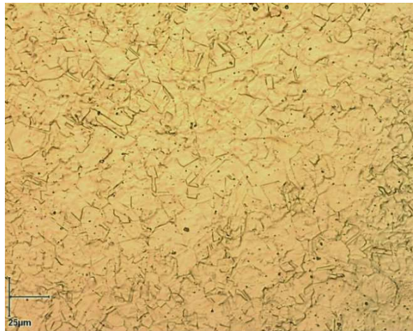
Figure 2.2 : Micrographie de la surface de l'alliage Fe-Ni-Co après attaque électrolytique.
