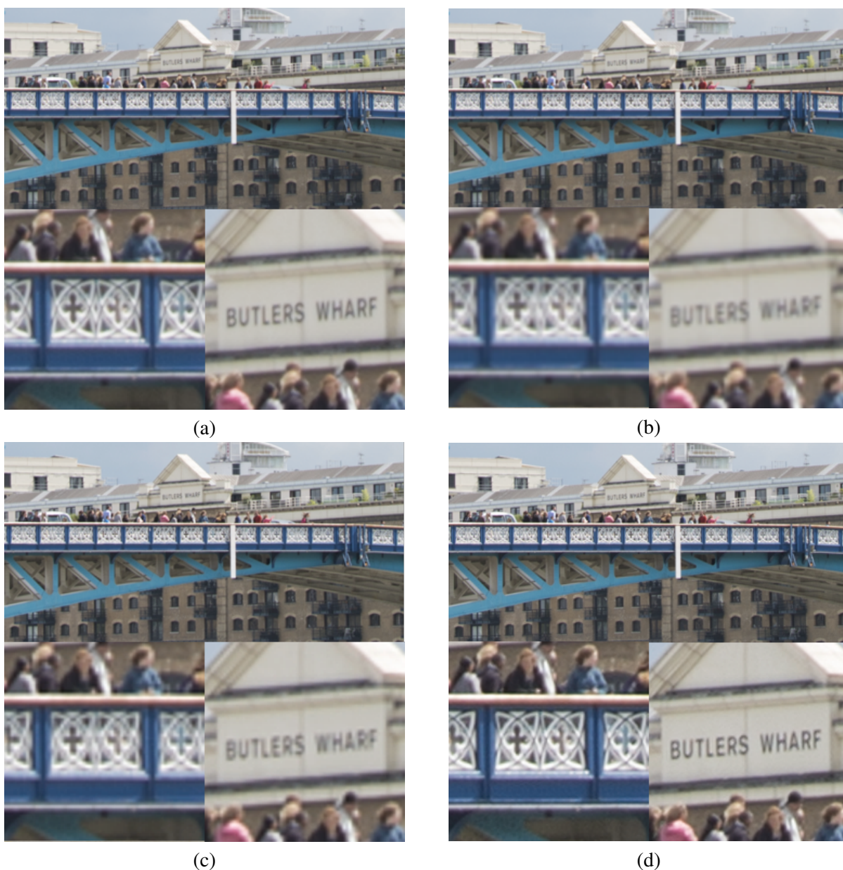
FIGURE 3.3 – Exemple d’images issues des traitements utilisés pour la comparaison des métriques, (a) correspond à l’image source, (b) image floue provenant de T_1 , (c) image issue de T_2 : image provenant de T_1 suivit d’un rehaussement de contours et l’image (d) correspond au traitement T_3 , rehaussement de contours appliqué à l’image source.
