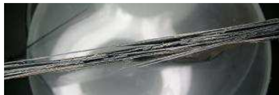
Figure 3.27. Tranche d'une éprouvette réparée après rupture en fatigue sous une charge de
