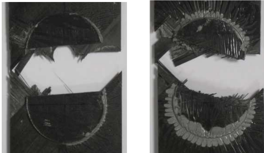
(a) Réparation par patchs [90]4
