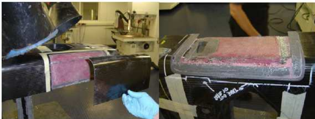
Figure 1.3. Réparation d'un châssis du véhicule F1 par patches composites [8]
