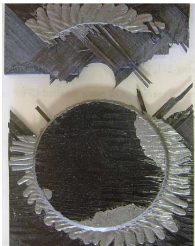
Figure 4.12. Faciès de rupture des réparations par patches [90/0/45/-45]
