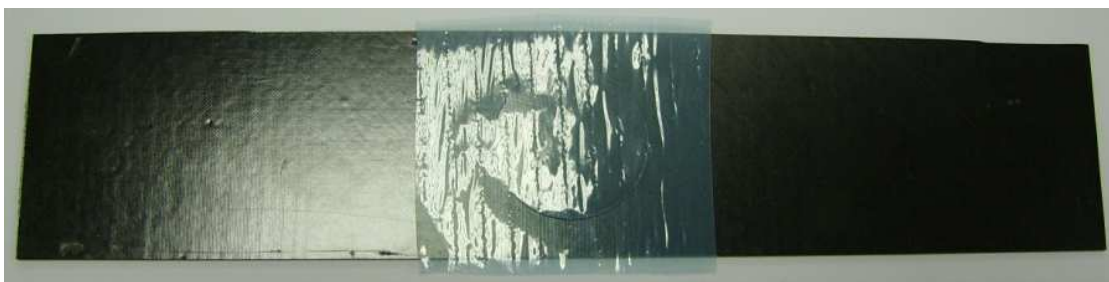
Figure 2.6. Mise en position des patches durs avec un film démoulant
