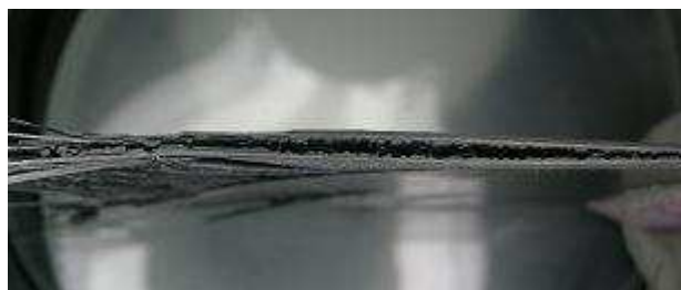
Figure 3.18. Rupture d'une éprouvette vierge sollicitée en traction cyclique avec R=0,1 et \sigma_{\max}=80\% \sigma_{\text{rup}}^0
