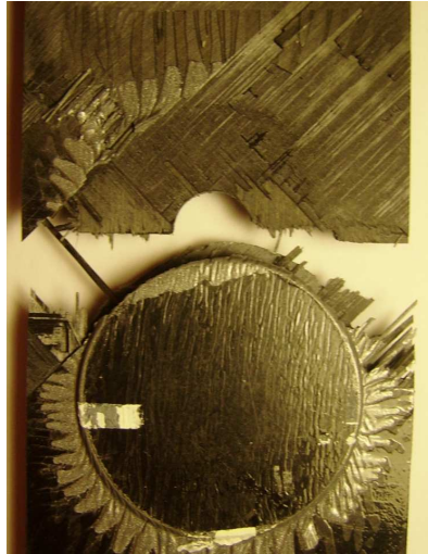
Figure 4.11. Faciès de rupture des réparations par les patches [45/-45]s
