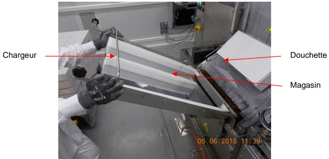
Figure 6 : Passage des dernières ampoules dans la laveuse avec le chargeur
