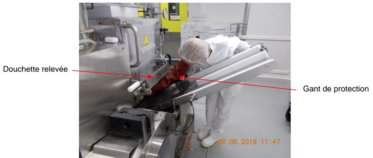
Figure 7 : Elimination manuelle des ampoules à l'entrée de la laveuse
