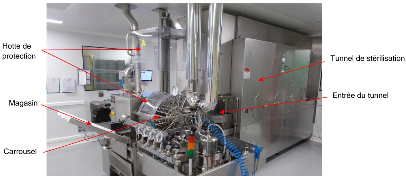
Figure 1 : Équipement de l'atelier Laveuse/Tunnel
