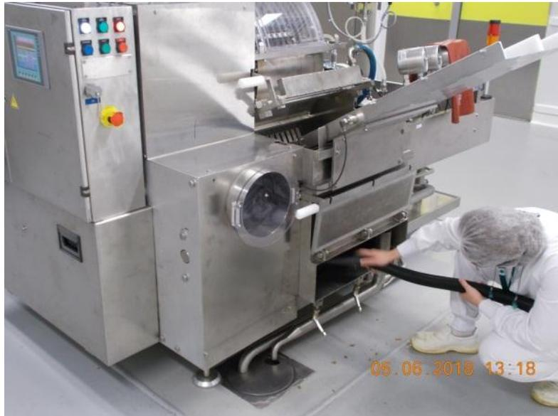
Figure 12 : Nettoyage de la trappe située sous la laveuse
