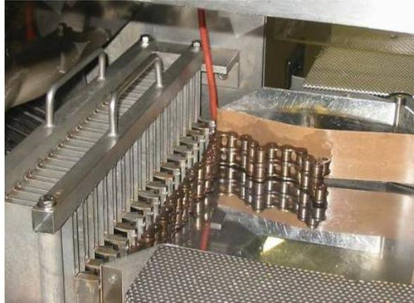
Figure 14 : Pose d'une chaîne à la sortie laveuse
