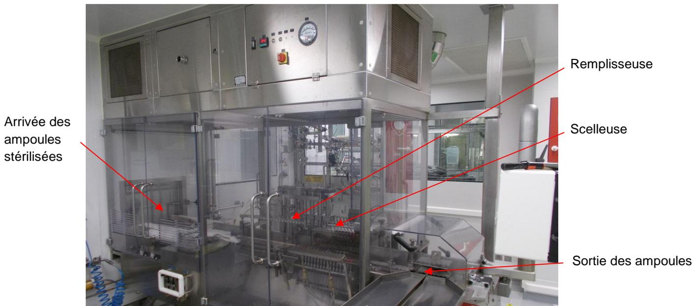
Figure 2 : Equipement de l'atelier Remplisseuse
