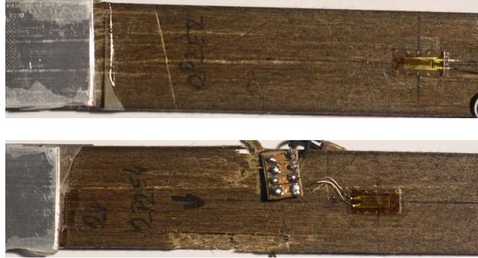
*Figure 2.8: Rupture des éprouvettes 0\_P2E2 et 0\_P2E4*
