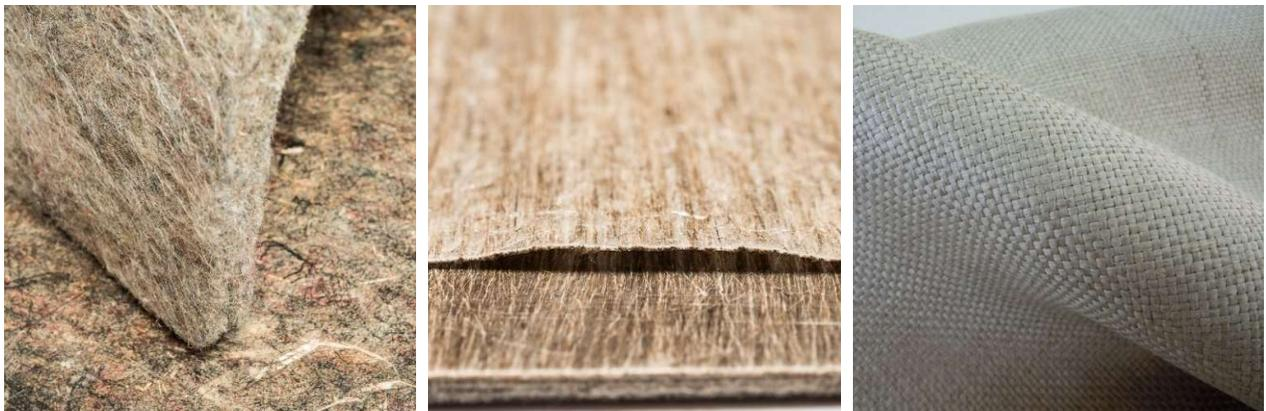
*Figure 1.4 : Formes commerciales de différents renforts de fibres de lin pour composites : a) mat de fibres [18]; b) renfort unidirectionnel [50]; c) renfort tissé [51]*
