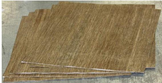
Figure 2.2: Plis pour une plaque à direction de 0°
