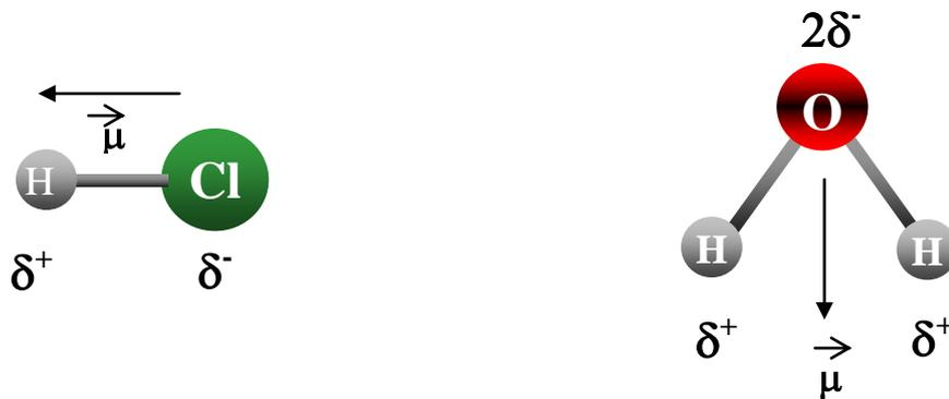
**Figure 2:** Moment dipolaire dans le cas de molécules asymétriques (H<sub>2</sub>O et HCl)
