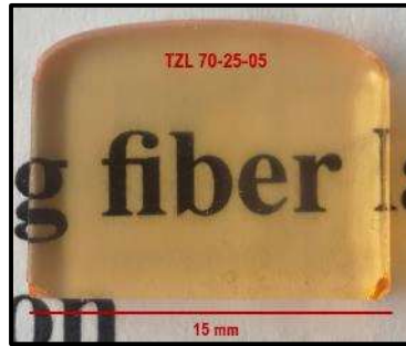
Fig. III. 20. Photo d'un verre massif de TZL 70-25-05 (mol. %) après polissage
