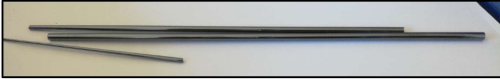
Fig. V. 6. Tiges GST cœur/gaine préparées par fibrage
