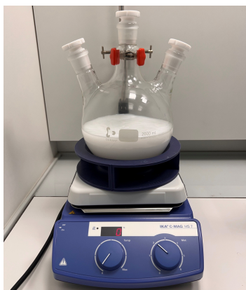
Figure 3.7 : Photo du montage expérimental utilisé pour la synthèse de nanoparticules de SiO 2 à grande échelle (1 L). La synthèse est réalisée dans un ballon de 2 L. La vitesse d'agitation est maintenue à 500 rpm.
