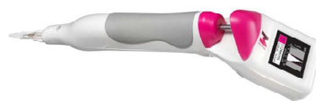
figure 10 une pipette de comptage de la marque Scepter basée sur le principe Coulter 11
