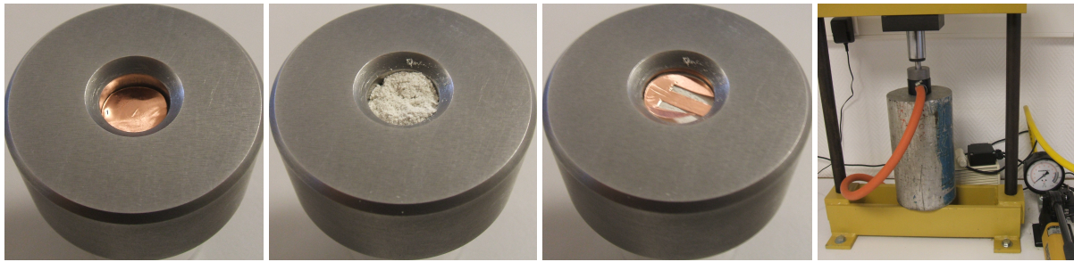
FIG. 3.6 – Étapes de fabrication d'un capteur microonde avec un matériau sensible utilisé comme substrat.
